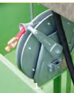
1. Система заземления. Grounding system.
