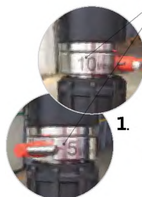
1. регулирующего ключа с функцией дозирования 5-10 л. Flow rate 5-10 L/min adjusting key.
